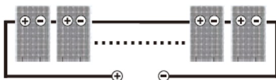
Połączenie szeregowe dla większego napięcia
